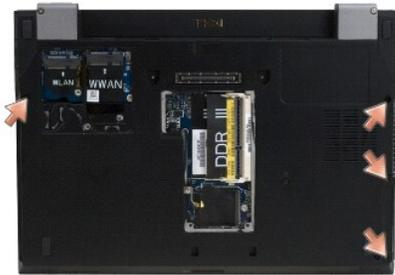
6. 將電腦正面朝上放置，並將 5 顆 M2.5 x 5-mm 螺絲和 5 顆 M2.5 x 8-mm 螺絲從手掌墊上方卸下。
